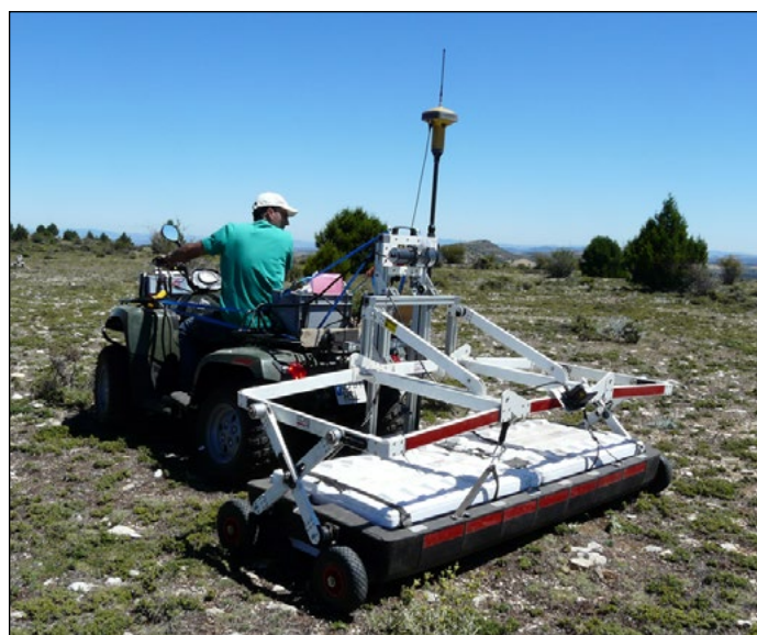
Antena de georradar de 200 MHz con tracción mediante quad
