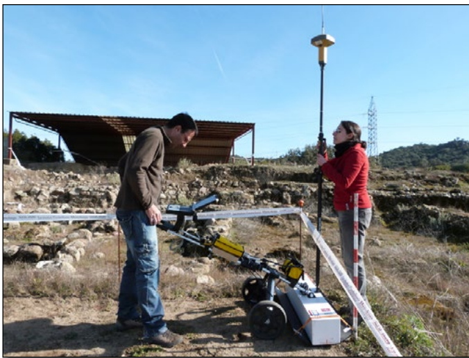
Antena de georradar de 600 MHz con referenciación GPS
